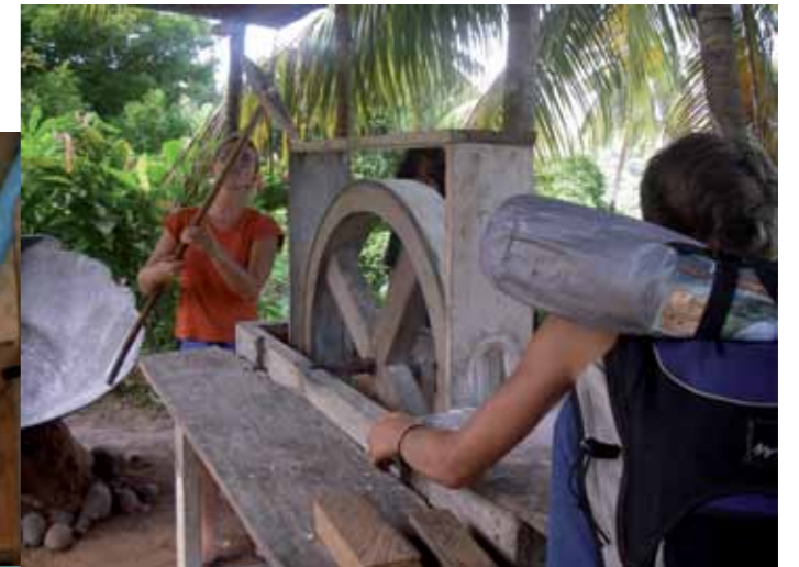
Kélig et Romain manipulent la roue qui broie le manioc (tubercule). Avec la farine, on fait des galettes de cassaves.
